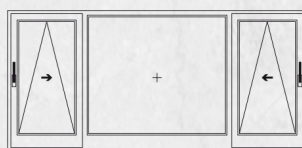
Схема К 2 Параллельно-сдвижные створки, 1 Глухая створка Тип открывания: левое (активная створка), правое (активная створка)
