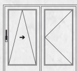
Схема А 1 Параллельно-сдвижная, 1 Поворотная створка Тип открывания: левое
