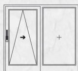
Схема А 1 Параллельно-сдвижная, 1 Глухая створка Тип открывания: левое
